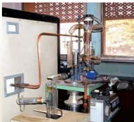
Fig. 5 : Knudsen effusion assembly
